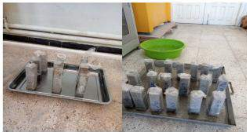
Figure 5. Essai d'absorption d'eau capillaire.
